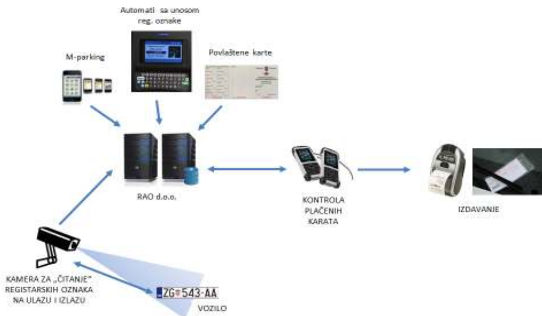
Slika 17: Shema sustava za automatsko čitanje registarskih oznaka
